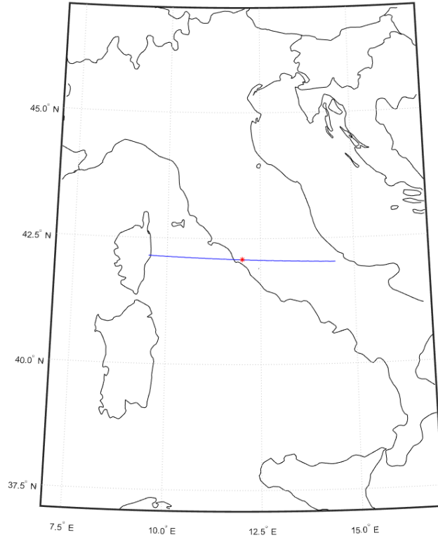
Figura 3.22: curva di Geo-localizzazione FDOA, zoom nella posizione della sorgente interferente
