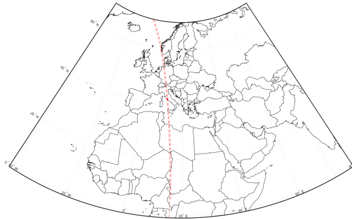
Figura 3.19: incertezza nella curva di Geo-localizzazione TDOA per effetto dell'errore di misura
