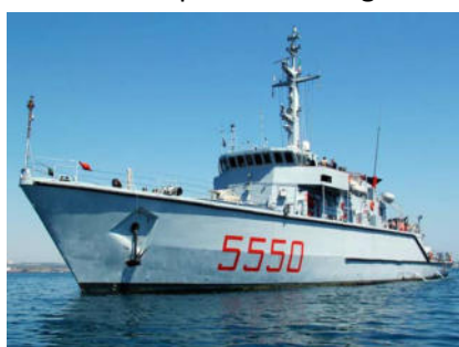
Figura 28: unità cacciamine a ridotta segnatura magnetica
