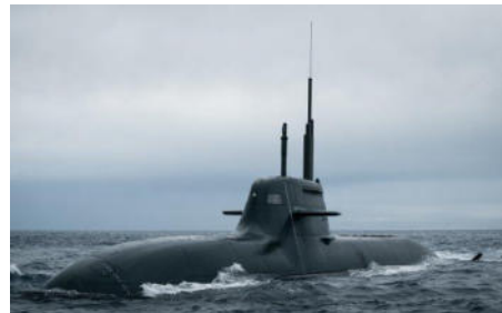
Figura 29: sottomarino classe U212A in scafo amagnetico
