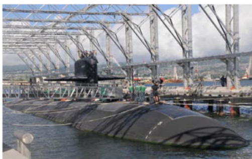
Figura 33: sistema di deperming di tipo drive-in
