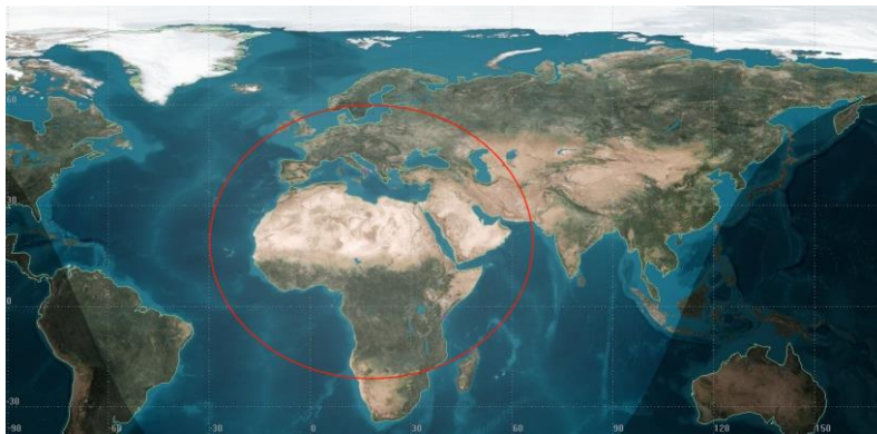
Area di copertura del satellite GEO
