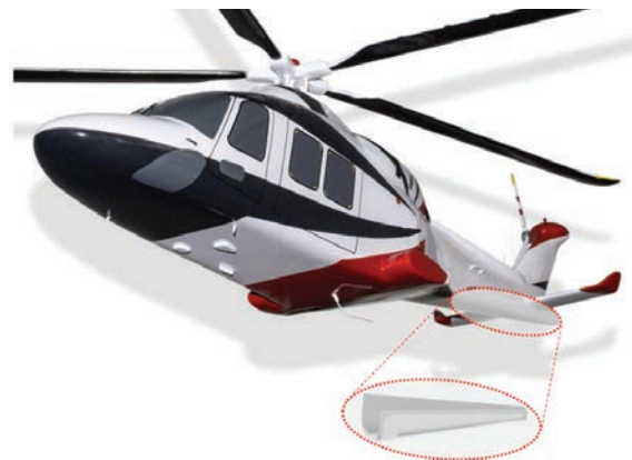
Figura 1 – Esempio di posizionamento dell'antenna HF conforme alla coda dell'elicottero
