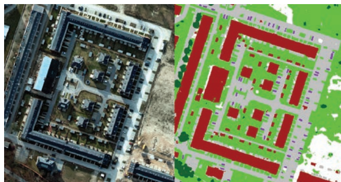
Esempio di classificazione automatica di una immagine satellitare tramite algoritmi di Deep Learning Semantic Segmentation. Credits: Hexagon
